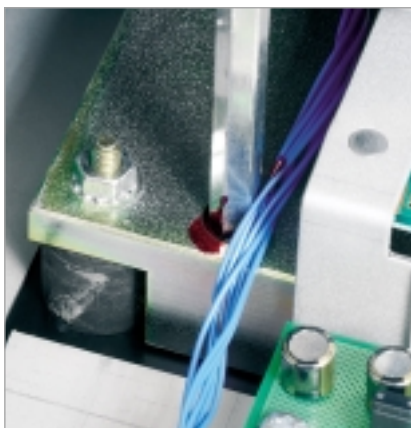
Der dicke, schwere Metallblock stellt das Laufwerk wirklich absolut ruhig
