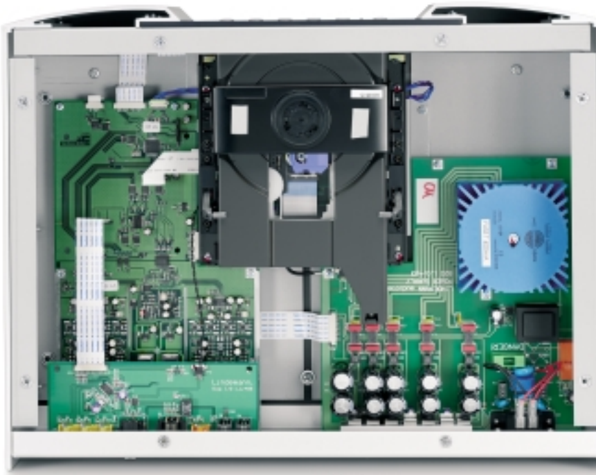
Links die Signalverarbeitung auf zwei Ebenen, rechts das aufwendige Netzteil mit Filtern und diversen stabilisierten Spannungen
