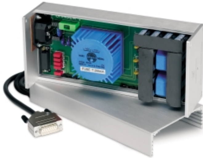
Auch das externe Netzteil für die analogen Abteilungen ist blitzsauber aufgebaut
