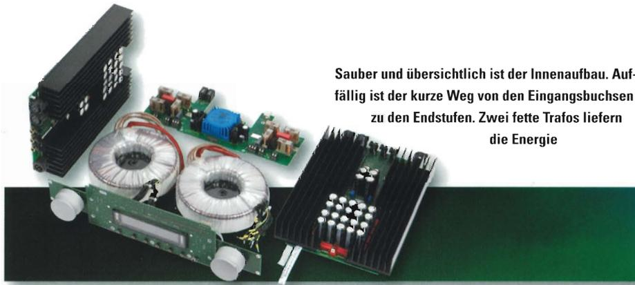
Sauber und übersichtlich ist der Innenaufbau. Auffällig ist der kurze Weg von den Eingangsbuchsen zu den Endstufen. Zwei fette Trafos liefern die Energie
