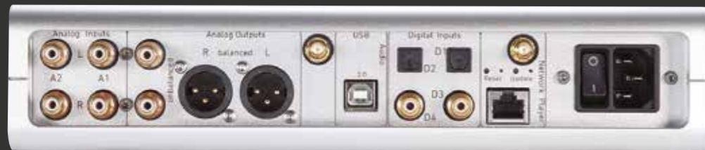
◀ Das Musicbook vereint auf seinem Gehäuserückendeckel eine erstaunliche Vielzahl ausnahmslos vergoldeter Anschlüsse.
