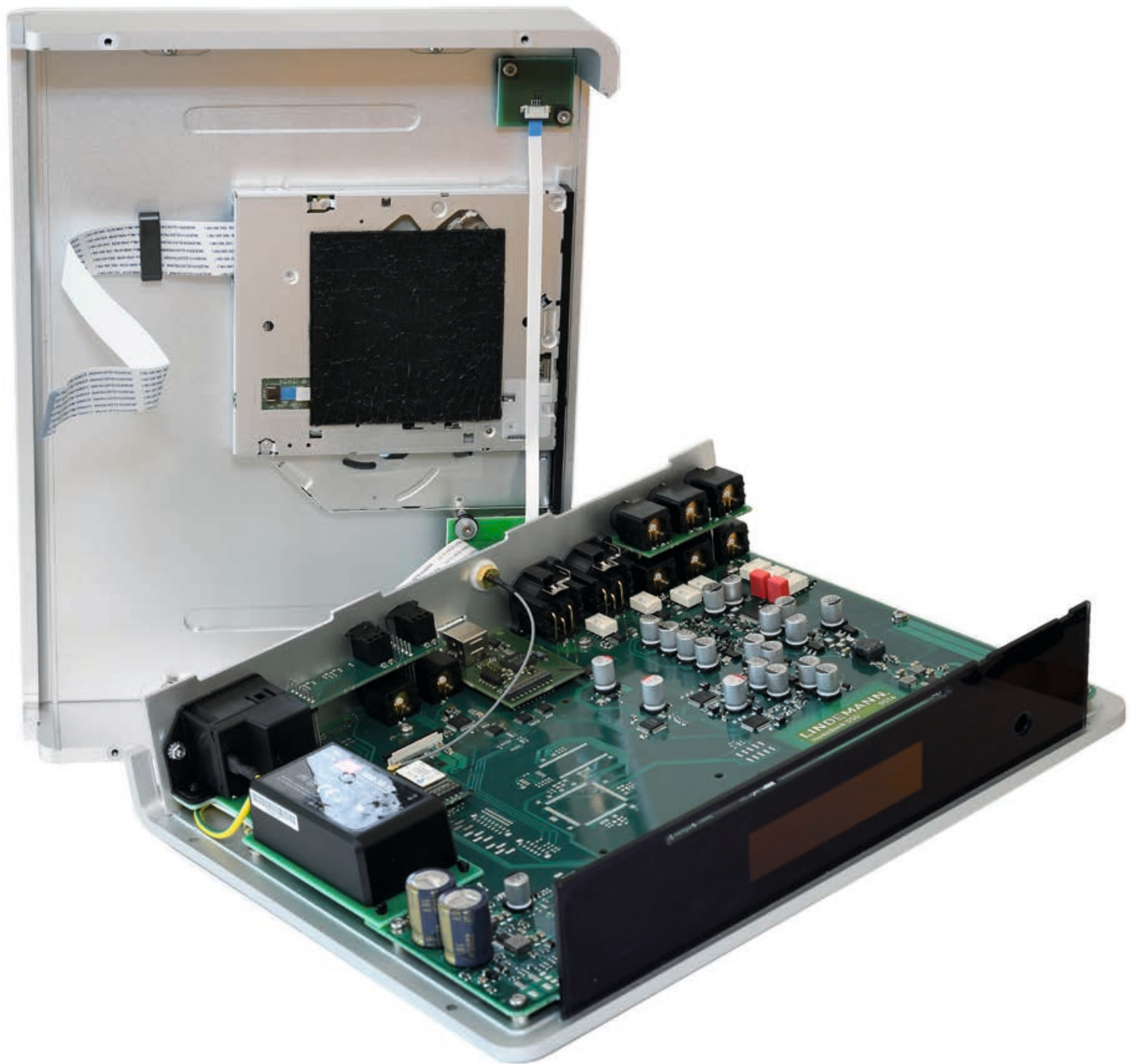
Das TEAC-CD-Laufwerk ist im dickwandigen Aludeckel angebracht.
