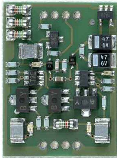
Das „Herzstück“ – die SEPP-Schaltung, ausgeführt in SMD-Technik
