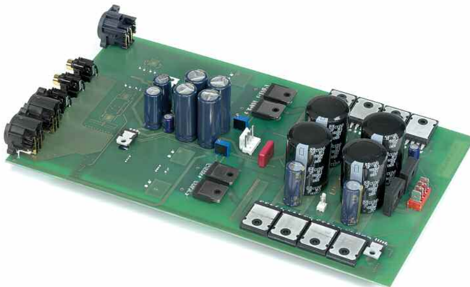
Auf der Oberseite der Hauptplatine sitzen auch gleich die Endtransistoren
