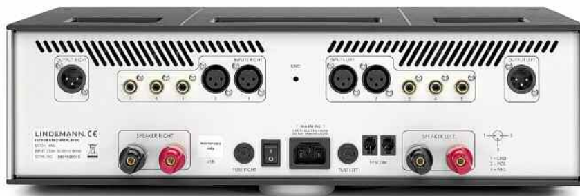
Bereits am Anschlussfeld erkennt man den Doppel-Mono-Aufbau
