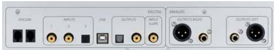
Das reichhaltig bestückte Anschlussfeld umfasst Analog-Ausgänge in Cinch und XLR, vier digitale Eingänge inklusive USB für Fremdgeräte sowie je einen koaxialen und Lichtleiter-Digital-Ausgang
